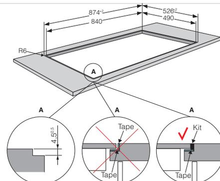
Built-Dimensionis (for flush Installazione)
